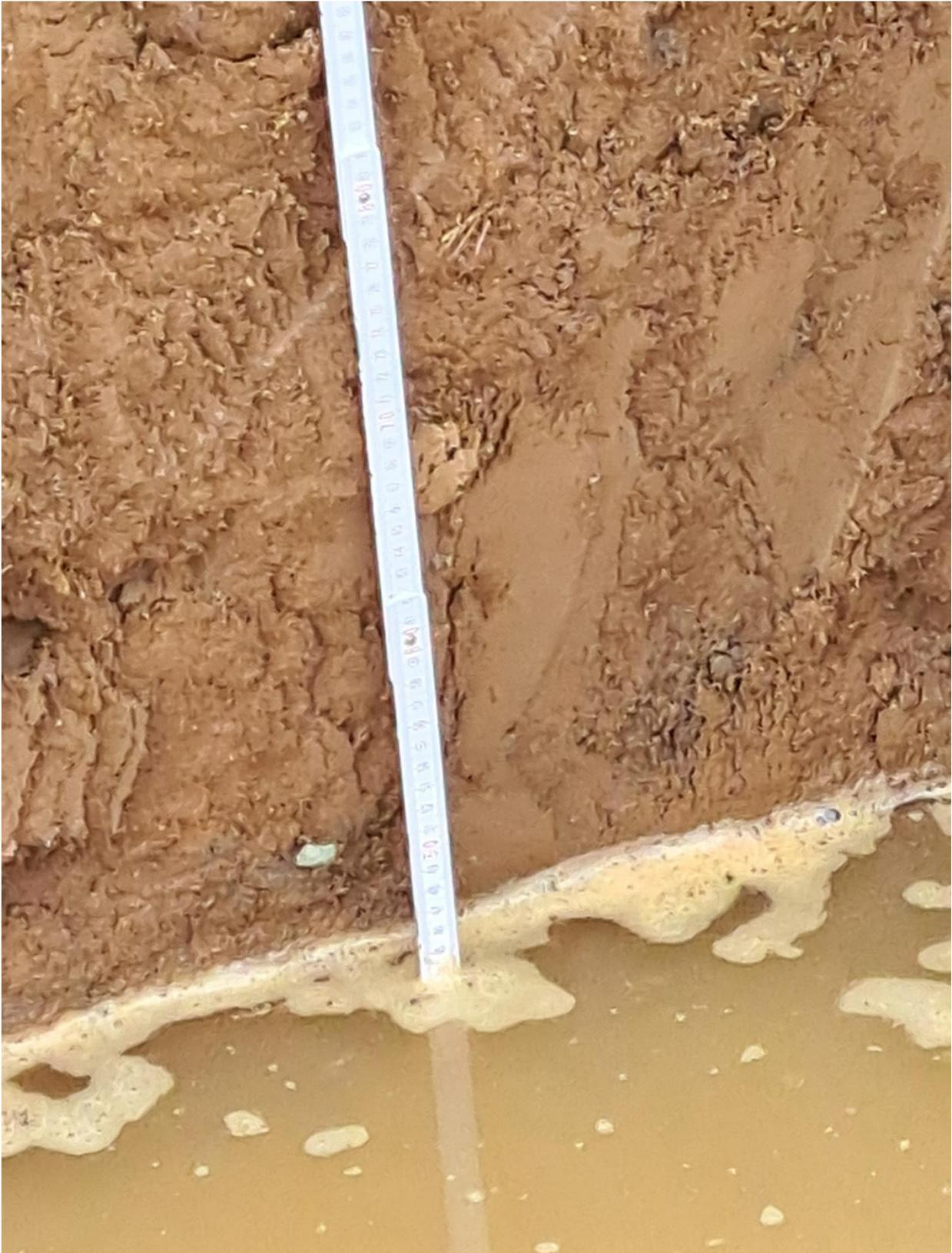
Abb. 3: Wasserstand 60 min. nach Beginn des Versuches bei 0,445 m
