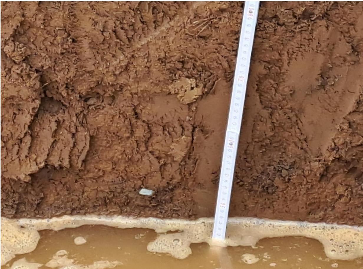
Abb. 2: Wasserstand zu Beginn des Versuches bei 0,445 m
